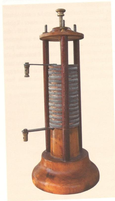
Abb. 1: Historischer Aufbau der Volta'schen Säule
