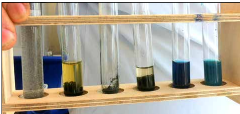
Abb. 6: Links: Chloridnachweis mit Silbernitrat; Rechts: Nachweis von Eisen-Ionen als Berliner Blau
