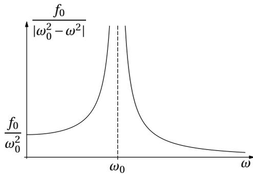
Das Lösungsverfahren versagt, denn die Inhomogenität  $f_0 \cos \omega_0 t$  ist eine Lösung der homogenen Differentialgleichung  $\ddot{x} + \omega_0^2 x = 0$ . In einem solchen Fall spricht man von einer *Resonanz* (-katastrophe). Dieser Begriff ist nicht auf trigonometrische Funktionen beschränkt.
