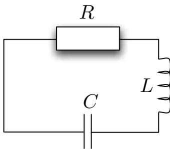
beschrieben. Im übertragenen Sinne ist dabei der Ohmsche Widerstand  $R$  die Dämpfung, die Induktivität  $L$  die Trägheit und der Kehrwert  $\frac{1}{C}$  der Kapazität die Federkonstante. Die Eigenfrequenz ist dann durch
