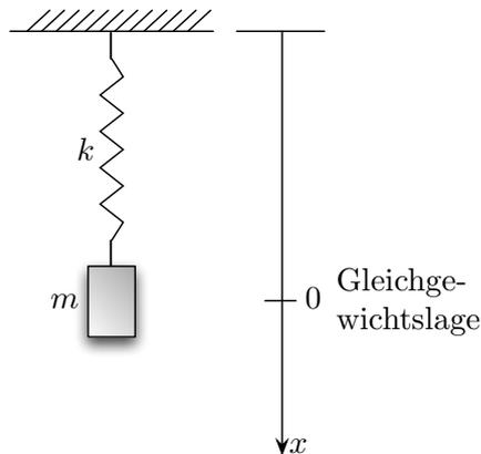
Das ist die Differentialgleichung für die freie, ungedämpfte Schwingung (siehe Beispiel 5 auf unserer Liste von Differentialgleichungen). Es ist eine lineare, homogene Differentialgleichung 2. Ordnung mit den konstanten Koeffizienten  $a = 1$ ,  $b = 0$  und  $c = \omega_0^2$ .
