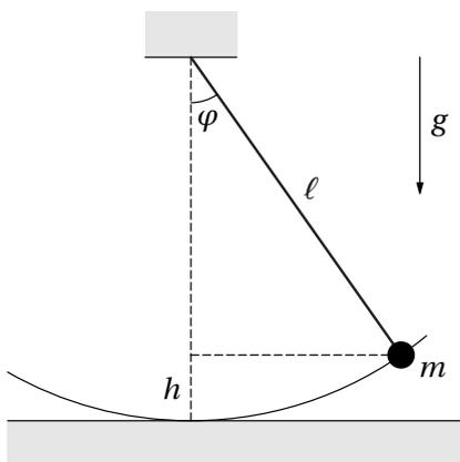
Mit der Bahngeschwindigkeit  $\ell\dot{\varphi}$  des Pendelkörpers und seiner Anhebung  $h = \ell(1 - \cos \varphi)$  über den tiefsten Punkt seiner Kreisbahn gilt der Energie-Erhaltungssatz
